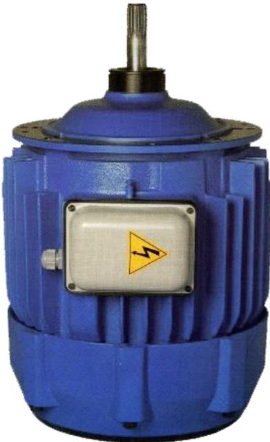
устанавливается на механизм подъема тельферов производства Болгария. Электродвигатели **КГ**, **КГЕ**, **КГ** представляют собой сочетание электродвигателя с конусным ротором и конусным тормозом, действующим непосредственно через аксиальное смещение ротора под воздействием пружины.
